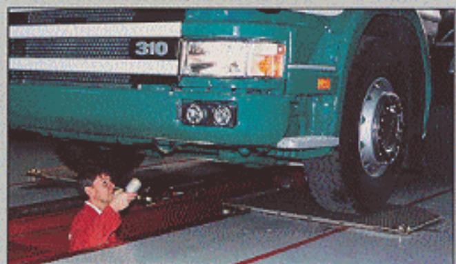
Před začátkem měření musíme na detektoru vůli zkонтrolovat nadměrné vůle v řízení a v ložiscích kol.
