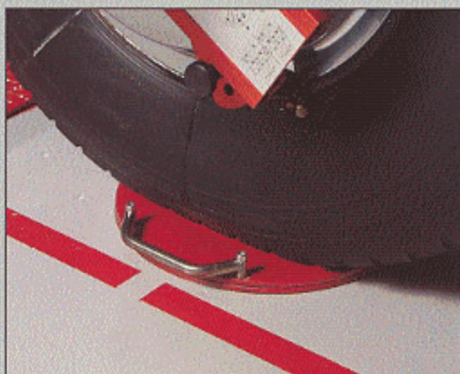
Antifrictkni točnice AM268 se skládají ze 2 hliníkových desek, uložených proti sobě přes kuličky. Ideální pomocník při nastavení sbíhavosti kol především u vozidel s více řízenými nápravami.
