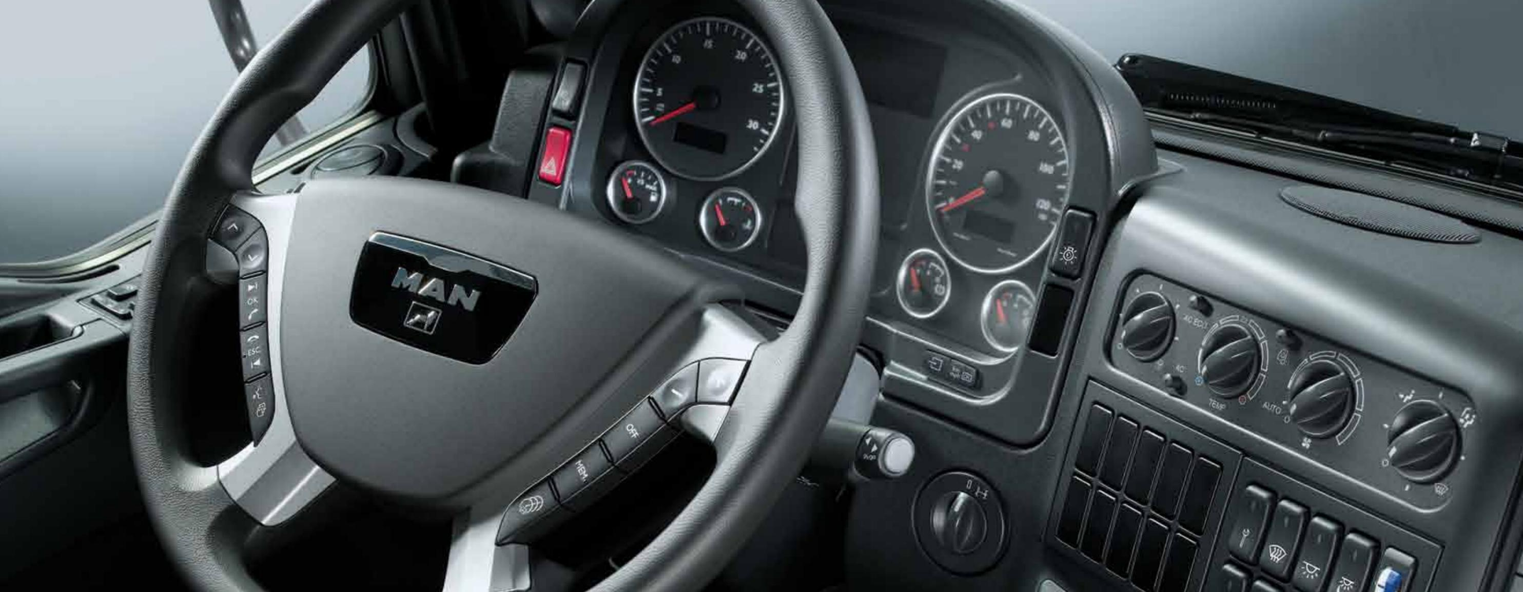
Multifunktionslenkrad mit Bedienfunktion u. a. für MAN Radio und Tempomat, serienmäßig im L- und LX-Fahrerhaus.
