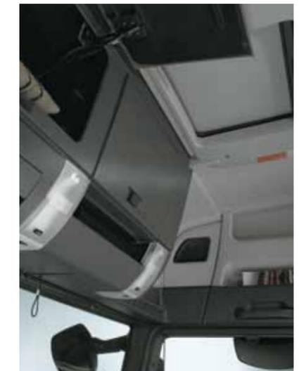
Ablagefach über der Frontscheibe und elektrisches Schiebehobdach im LX-Fahrerhaus.
