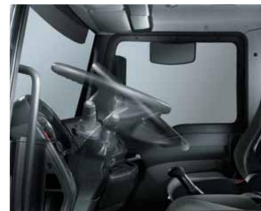
Lenkrad per Fußknopf stufenlos in Höhe und Neigung verstellbar.
