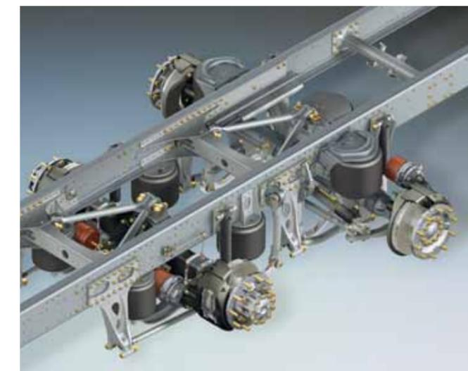
TGM Luftfederung an der gelenkten Nachlaufachse.
