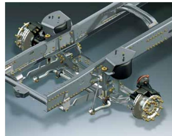
TGM Luftfederung an der Vorderachse.
