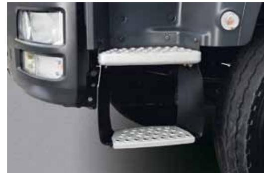
Flexibler Einstieg bei Lkw mit Stahlstoßfänger und Allradantrieb oder mittelhoher Bauart.
