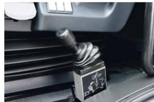
Bedienhebel für Kipphydraulik.
