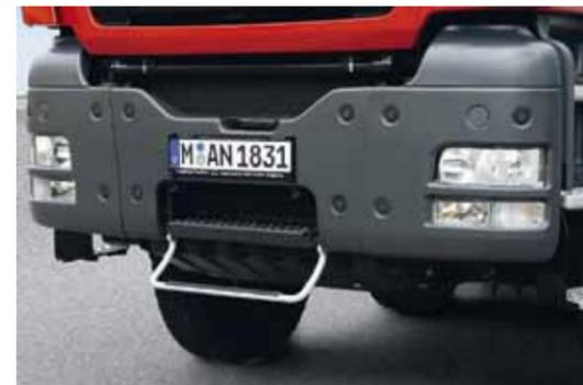
Stahlstoßfänger mit mittig angeordnetem Schleppmaul hinter KFZ-Kennzeichen und klappbarem Frontaufstieg.
