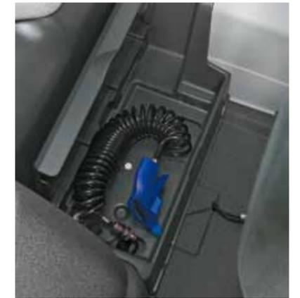
Einfache Innenraumreinigung mit Druckluft.
