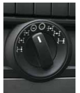
Drehschalter für Differenzialsperren und Verteilergetriebe.
