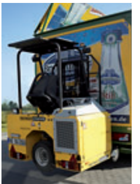
Mitnahmestapler für optimierte Transportlogistik.
