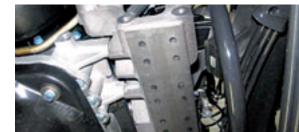
Anbaukonstruktion für Zusatzaggregate.
