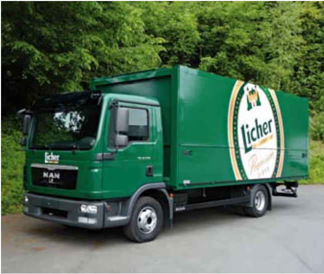
Beispiele: Ladungssicherung durch Aufbau nach VDI-Richtlinie 2700.
